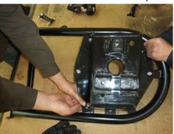
4. Заклеиваем места крепления кронштейна к кузову малярным скотчем.
