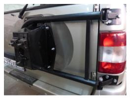
Если остается зазор, необходимо укоротить регулируемую тягу, повернув её на несколько оборотов. После чего снова проверить результат, закрыв дверь. В случае если кронштейн мешает закрытию двери (зазор отсутствует, а дверь ещё не закрыта), провести обратную операцию.
