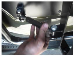
9. Крепим с помощью болтов и гаек кронштейн к кузову через ответные пластины.
